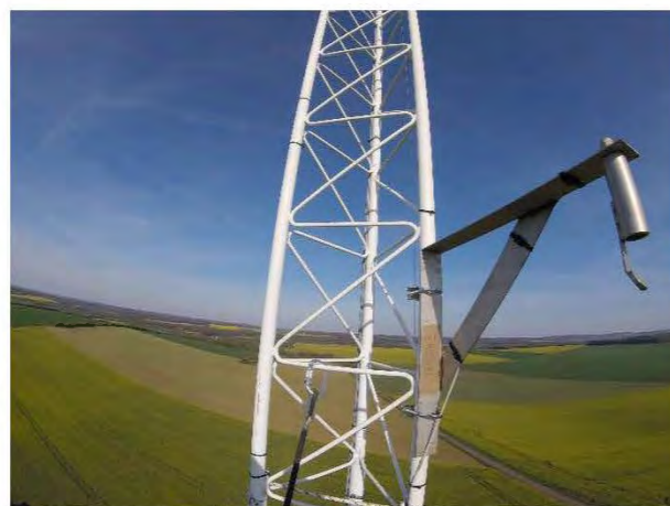
Photographie 21 : Potence métallique et système de protection du microphone. © Biotope
